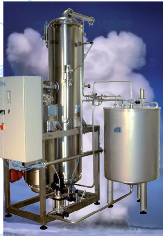
Reinstdampferzeuger DEWA CSG 600 mit einer Leistung von 600 kg / h bei 3 bar Reindampfdruck und 6 bar Heizdampfdruck, mit 300 Liter Vorlaufbehälter
